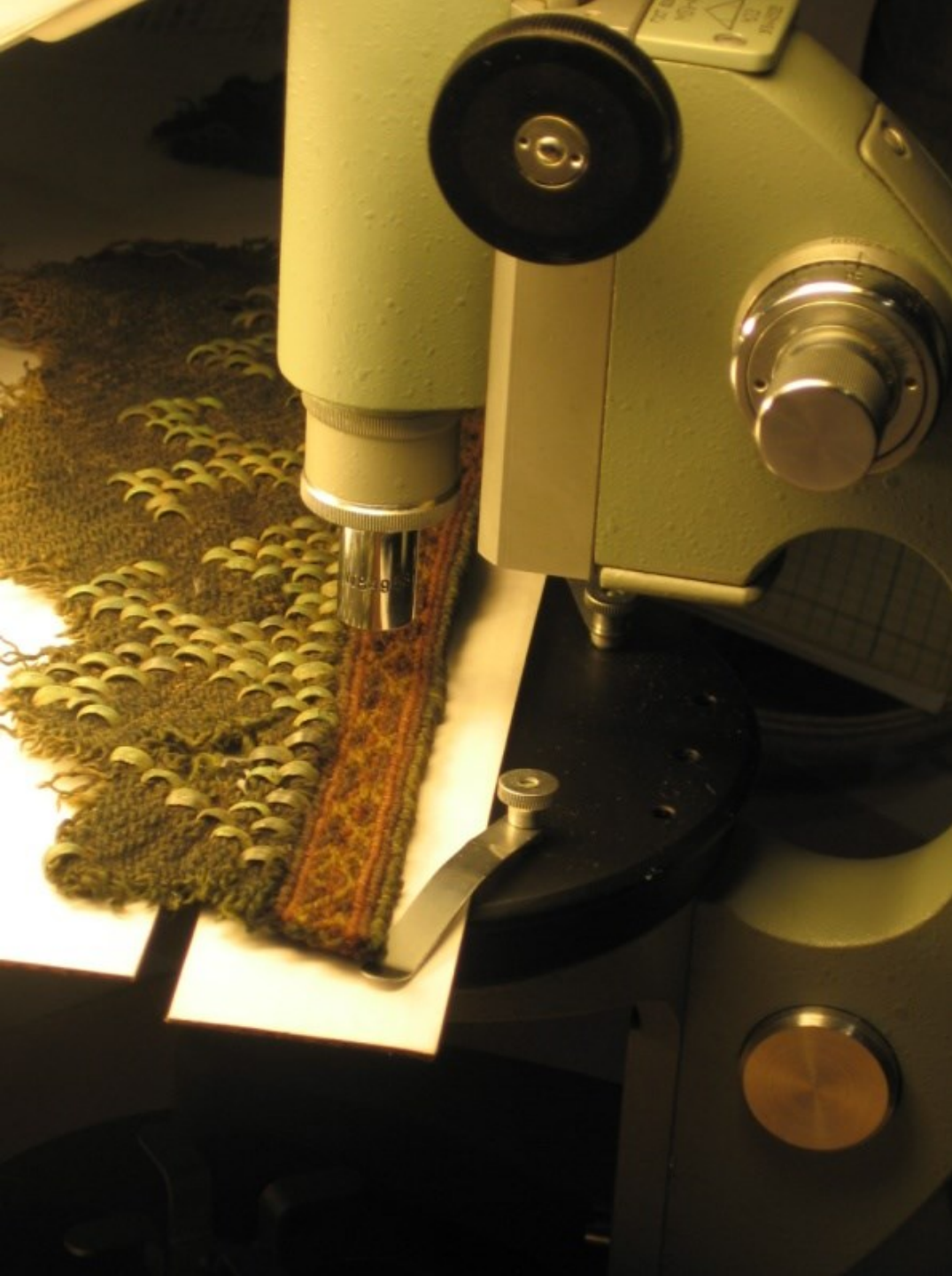
Mikroskopiskās izpētes process ar НПЗ optisko mikroskopu МБУ-4А
